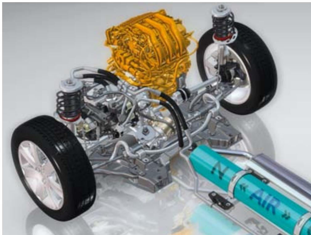
Chaîne de traction HYbrid Air, PSA
