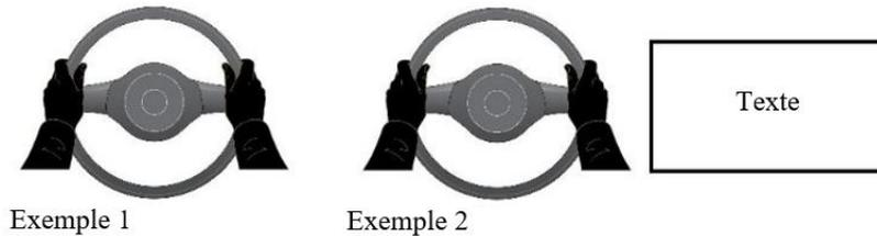
6.4.3.2 Au début de la manœuvre à risque minimal, le signal émis doit changer de caractéristiques pour souligner l'urgence d'une intervention du conducteur, par exemple, en faisant clignoter en rouge la commande de direction et en déplaçant les mains de l'information illustrée.
